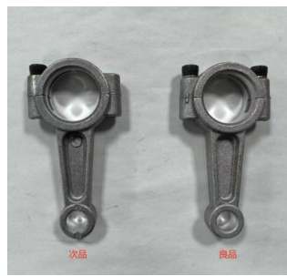
图 3 连杆良品、次品示意图
