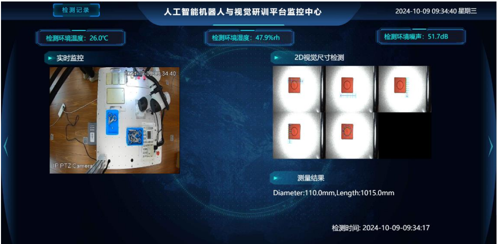
图 5 2D 相机检测画面及测量结果
