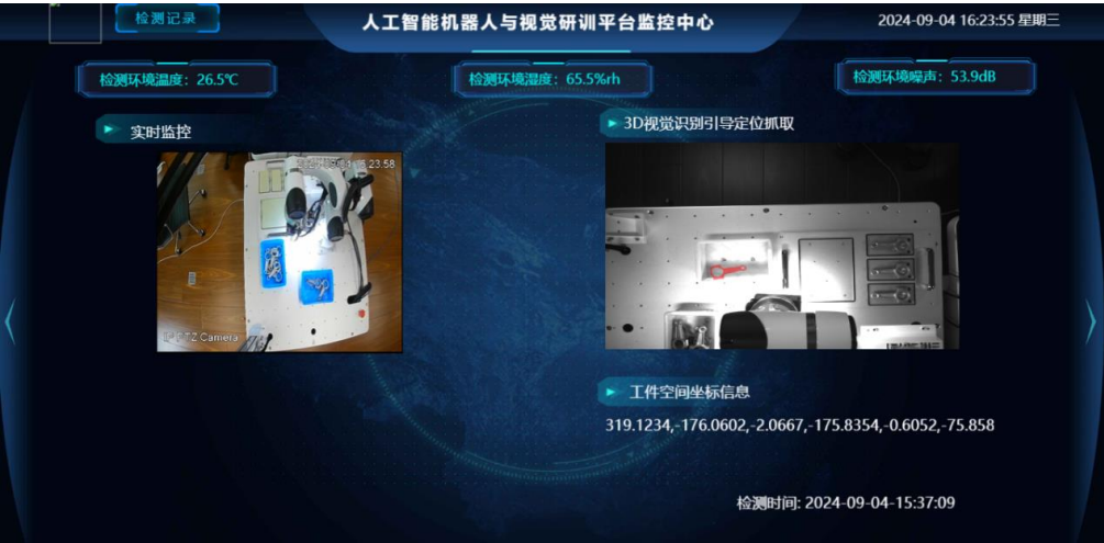
图 6 高精 3D 相机检测画面及工件空间坐标信息
