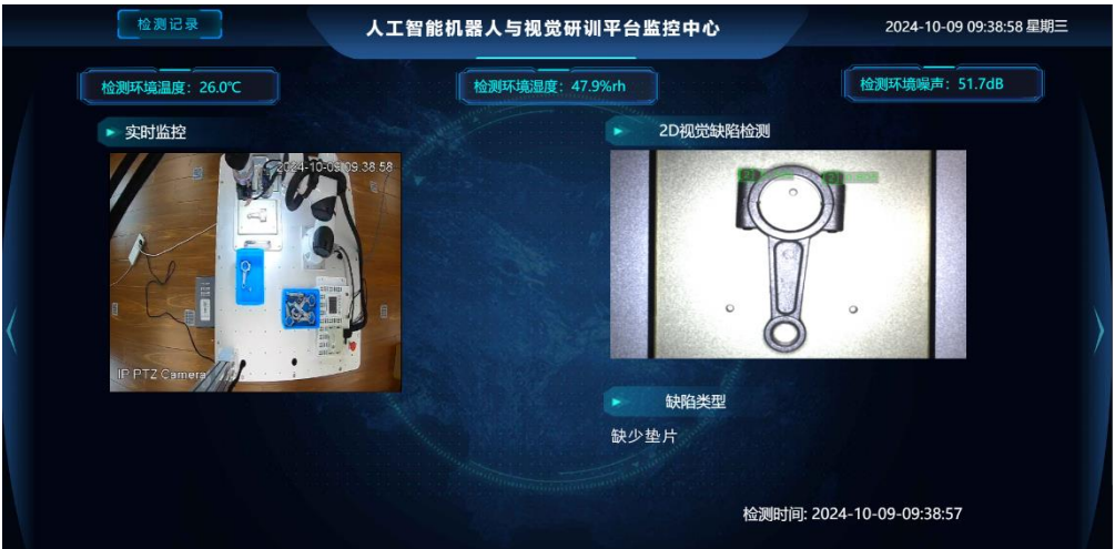
图 7 2D 相机缺陷检测画面及缺陷类型
